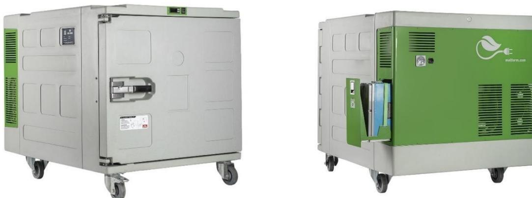
**I contenitori refrigerati Koala Green sono alimentati da una batteria LiFePO4, il che li rende completamente autonomi e indipendenti da un veicolo. La batteria estraibile può essere ricaricata collegando il Koala Green alla rete elettrica (230V) o con il caricatore esterno dopo averla rimossa dal gruppo frigorifero**
