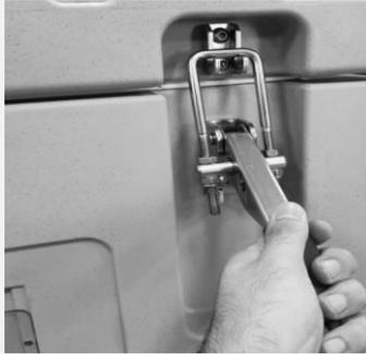
3. Tournez le levier jusqu'à ce que l'anneau métallique puisse être retiré du crochet fixé au couvercle.
