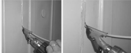
8 - Pour éteindre la machine à souder, réglez le bouton rouge (C) du thermostat sur la valeur 0, désactivez les éléments chauffants en réglant l'interrupteur noir (B) sur OFF, éteignez la machine à souder en réglant l'interrupteur gris (A) sur OFF et débranchez la fiche secteur de la prise 230V.
