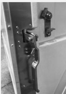
2 - Dévisser l'écrou et la vis M8 à l'aide de la rondelle Ø10mm correspondante.
