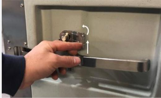
Saisissez la poignée avec la main droite et tournez-la dans le sens inverse des aiguilles d'une montre jusqu'à ce qu'elle se dégage du siège sur son support.
