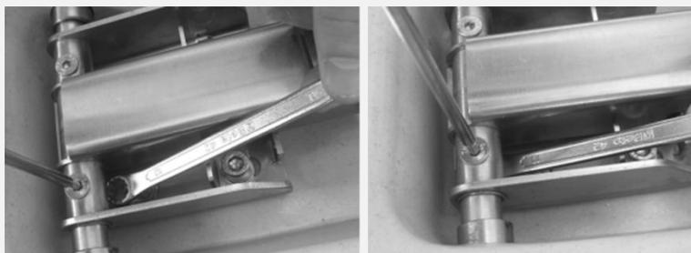
5 - Dévissez les 2 vis en acier inoxydable à tête cylindrique avec hexagone encastré M8x16 avec les rondelles en acier inoxydable à rainure relative (les deux dernières vis situées à droite)
