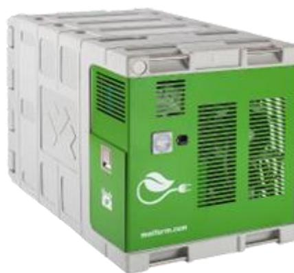
Les conteneurs réfrigérés Koala Green sont alimentés par une batterie LiFePO4, ce qui les rend complètement autonome et indépendant d'un véhicule. La batterie extractible peut être rechargée en connectant le Koala Green au secteur (230V) ou avec le chargeur externe après l'avoir enlevé du groupe frigorifique
